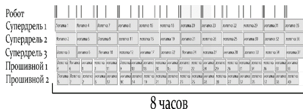
Рис. 7. Циклограмма изготовления отверстий перфорации РТК
