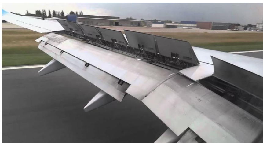
Рис. 2. Работа интерцепторов при посадке
