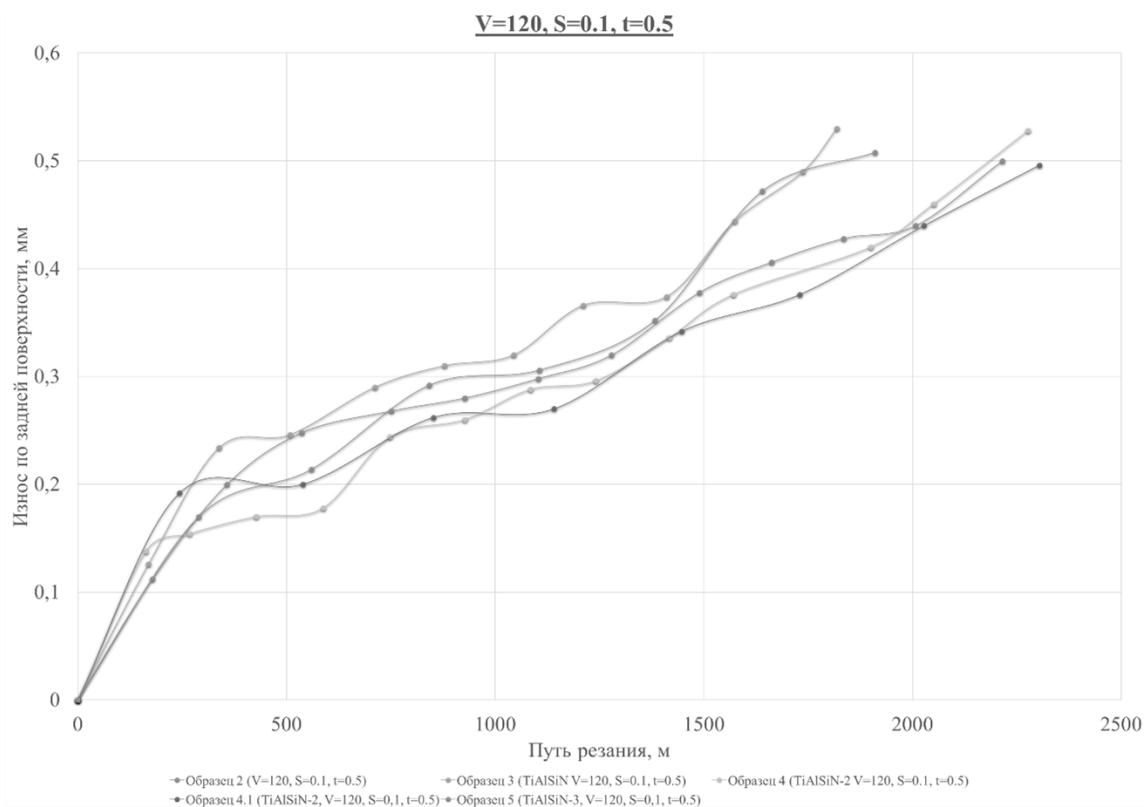
Рис. 2. Сводный график зависимости износа по задней поверхности от пути резания при обработке на оптимальных режимах
